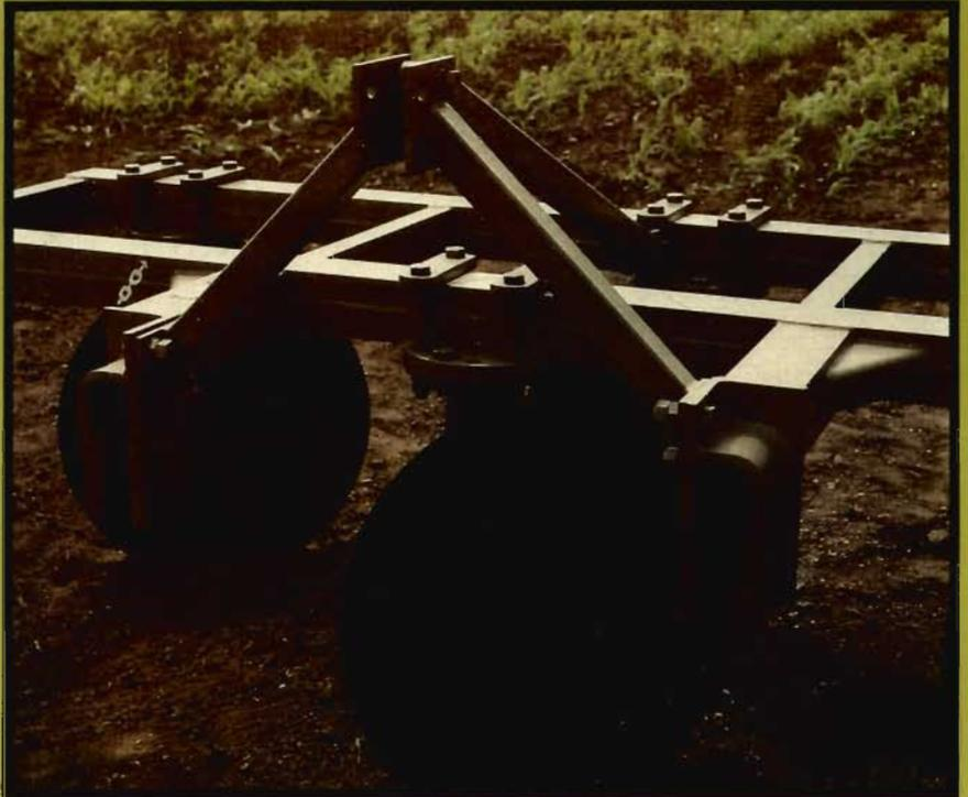
Zur Sicherung der gewünschten Dammhöhe und Dammform können Scheibenrichtungswinkel und Scheibenneigungswinkel eingestellt werden.
