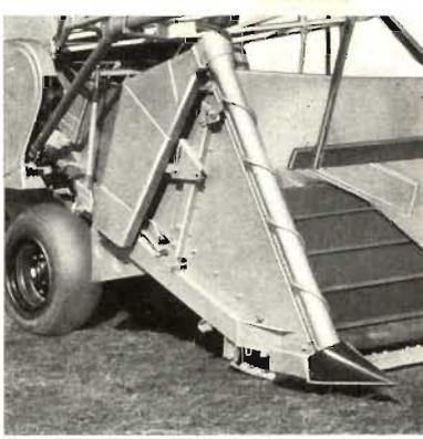
Der Halmteiler trennt hochhalmige und durch Windbruch liegende Bestände vom geschnittenen Erntegut.
