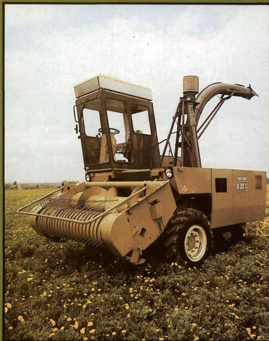
Vor und unterhalb der Fahrerkabine angeordnet, erlaubt der Schwadaufnehmer E 294 eine gute Übersicht über den Arbeitsvorgang und die Bodenbeschaffenheit. Zum Transport auf öffentlichen Straßen kann das Aggregat an der Grundmaschine verbleiben.
