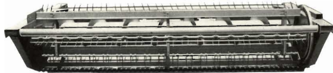
Feldfutterschneidwerk mit einer Arbeitsbreite von 4,20 m
