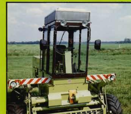
Fahrerkabine mit Sonnenschutzdach
