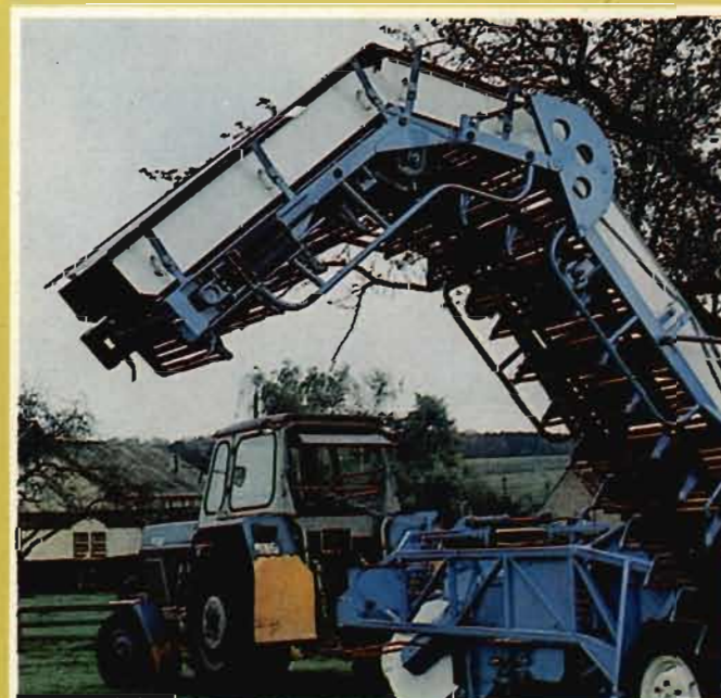
Ansicht des oberen Teils des Verladeelevators mit federbelasteter Spannstation (ohne Netzsutsche)
