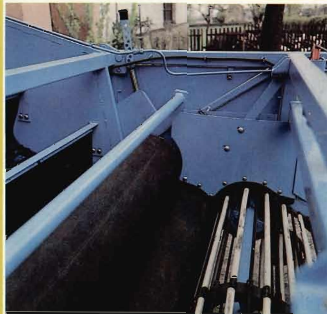
Ende der ersten Siebkette, die zwei Klutenpneuwalzen und die beiden Pralltücher über der zweiten Siebkette
