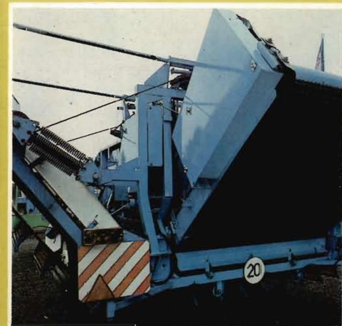
Hinteransicht mit Feinkrauttrennung und Teilansicht des Verladeelevators
