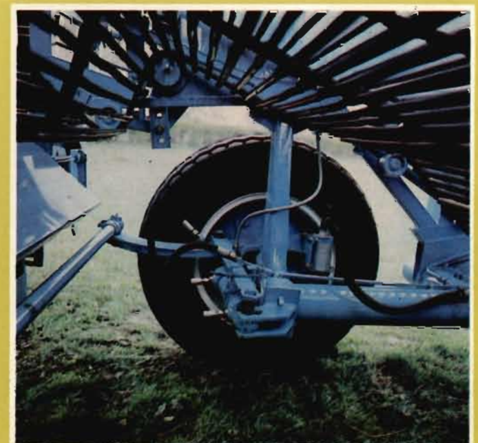
Auslegerachse mit hydraulischer Lenkung und Druckluftbremse
