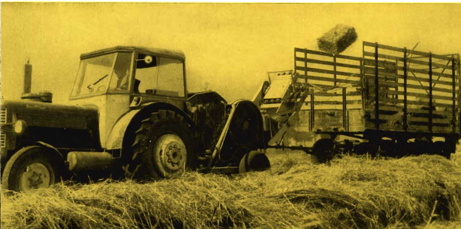
Der Ballenwerfer K 490 belädt selbsttätig den Anhänger und spart dadurch jegliches Bedienungspersonal ein
