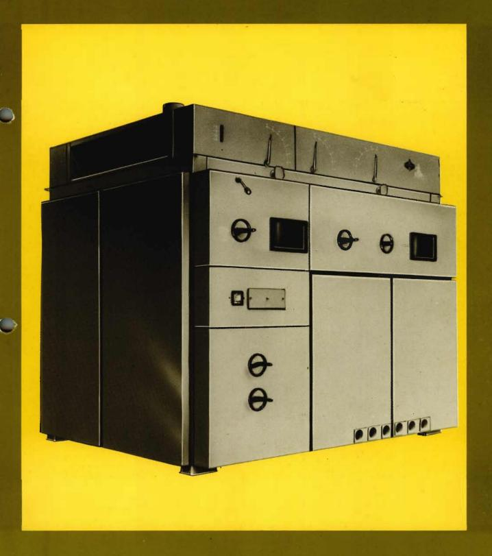
Der Siebsichter K 548 A ist eine anerkannte Spezialmaschine mit großer Durchlaufleistung für den komplizierten Aufbereitungsprozeß von Feinsämereien, Gras- und Kleesamen. Der dem Siebsichter nachgeordnete Zellenausleser K 236 A 01 schließt den Aufbereitungsprozeß mit Qualitätssaatgut ab.
