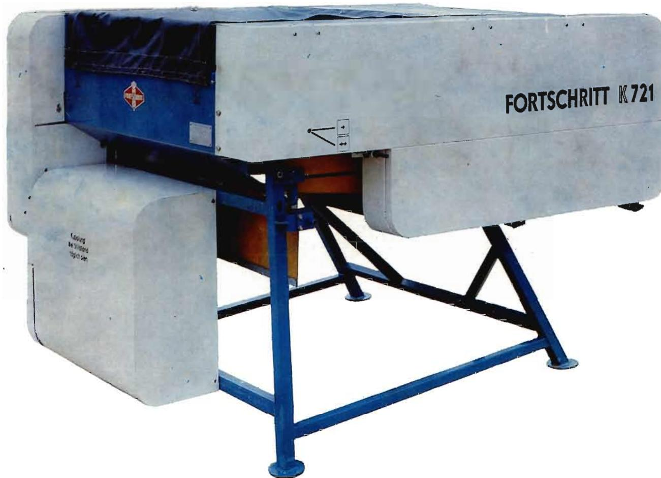
Mit Einsatz der modernen Kartoffelerntetechnik erhöhen sich die Beimengungsanteile der Kartoffelrohware. Im Rahmen der neuen Erntetechnik ist der Untergrößen-Erd- und Feinkrautabschneider K 720 im Einsatz, der die Untergrößen von der Gesamtrohware aussortiert.
