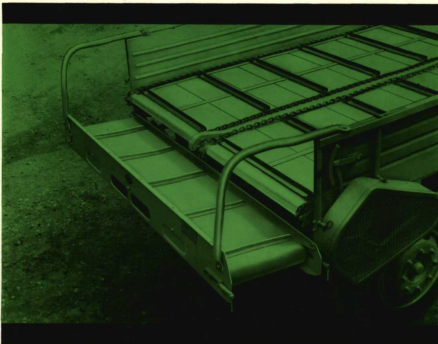
Mehrzweckanhänger T 087 mit angebaurem Querförderband T 257
