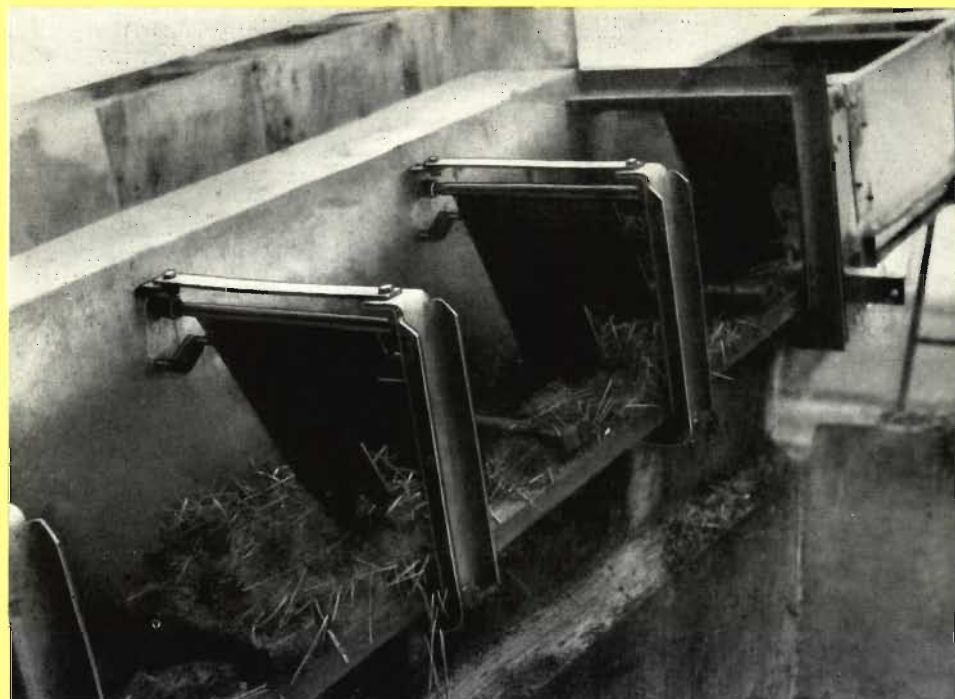
Klappgabeln am Schräglauf der Anlage
