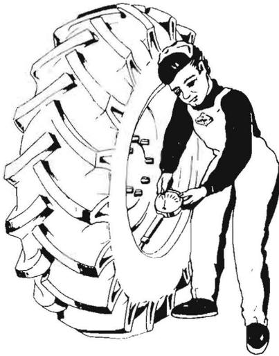
An den Treibradreifen 15–30 AS muß ein Luftüberdruck von **1,75 kp/cm<sup>2</sup>**, und an den Lenkrädern und Schneidwerkswagen 10–15 AM ein Luftüberdruck von **2,0 kp/cm<sup>2</sup>** vorhanden sein.
