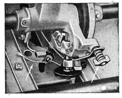
Der untere Ballenfaden zieht sich vorzeitig aus dem Halter heraus und schnellt nach oben, so daß er nicht von dem Finger eingeklemmt werden kann.
